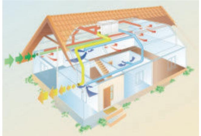
Dafür werden zwei Techniken angeboten. Bei einer Gerätart entzieht die Wärmepumpe der warmen, verbrauchten Luft die Wärme und heizt damit die von außen angesaugte Luft z.B. über einen Kreuzwärmetauscher auf. Die warme, frische Luft wird dann den Räumen zugeführt.
