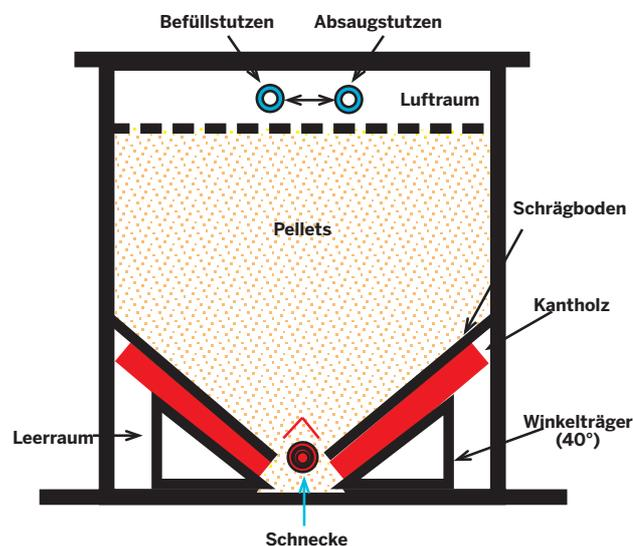
Schnitt eines Pelletlagerraumes
