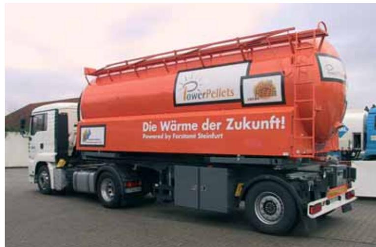
Holzpellets werden mittels Tankfahrzeug angeliefert
