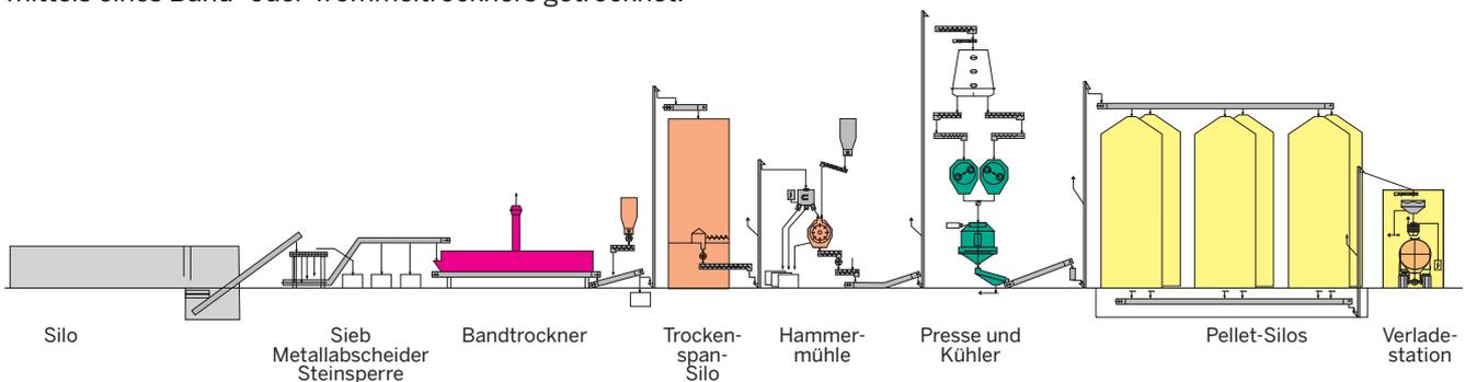
Schematische Darstellung der Pelletproduktion
