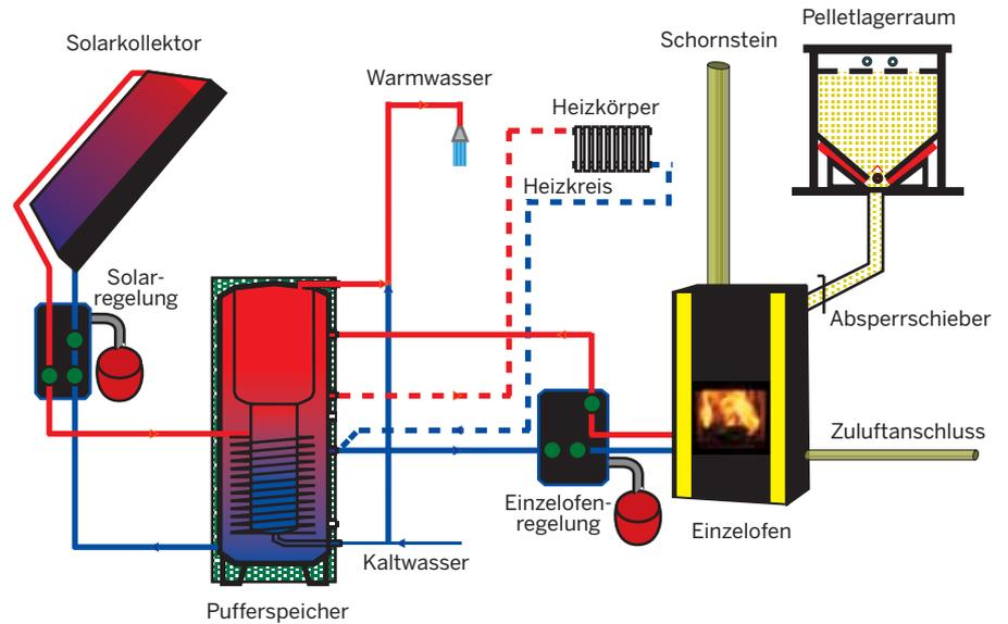
Beispiel einer Kombination von Solaranlage und Pellet-Einzelofen
