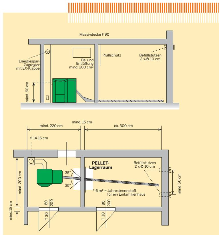
Beispiele für Grundriss und Ansicht eines Pelletlagerraumes mit den notwendigen bautechnischen Empfehlungen
